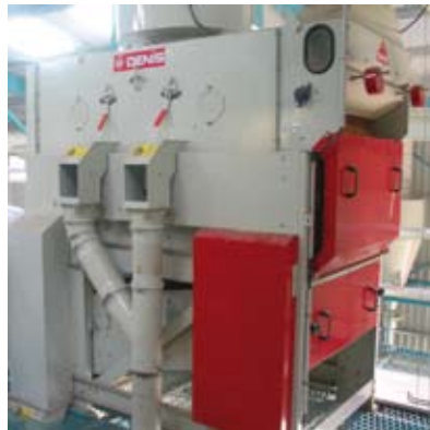
Schanzmelder an den Ausläufen der Abfallschnecken (NSD 3)
