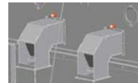
Schanzmelder an den Ausläufen der Abfallschnecken (NSD 3)
